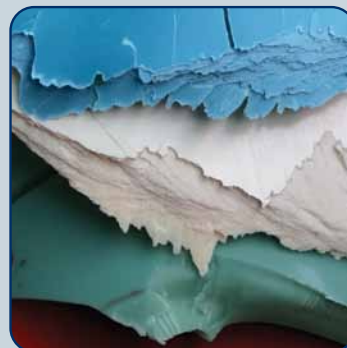
L'immagine mostra il PVC di struttura amorfa (colore verde) e il PVC di struttura laminare ottenuta grazie al processo di biorientazione molecolare (colore azzurro)
